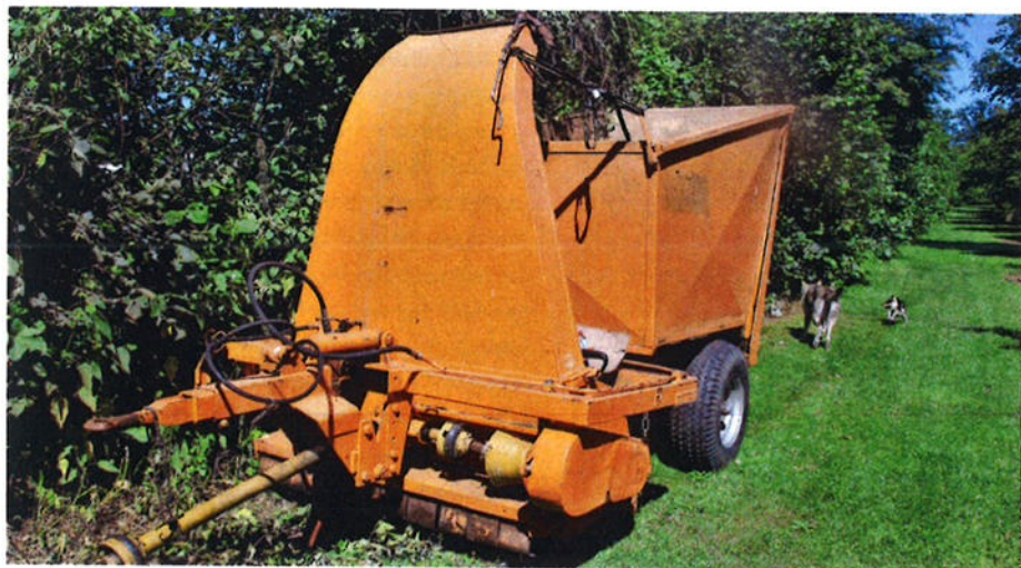
Harm Tuenter heeft, als techniekdocent, zelf zijn machinepark gecreëerd, zoals deze opraapwagen om snoeihout en blad te verzamelen.
